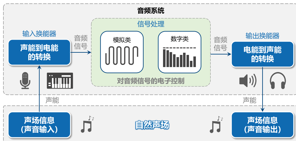
图 4.1: 声音录制与回放的实现过程链路图
