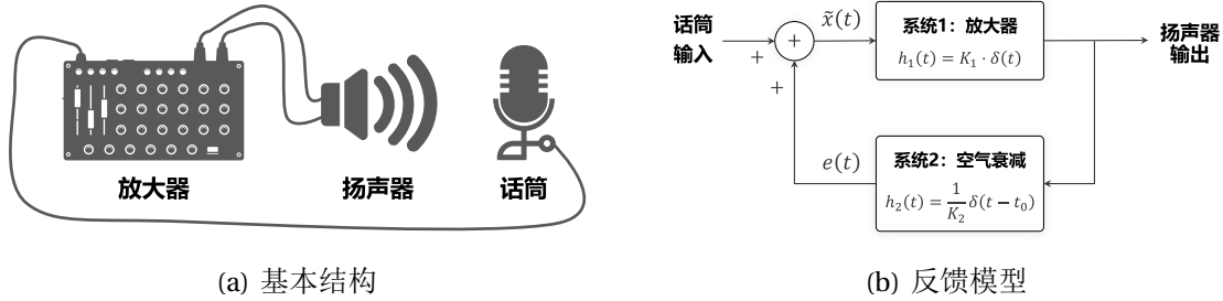
图 4.16: 话筒-扬声器音频反馈系统示意图
