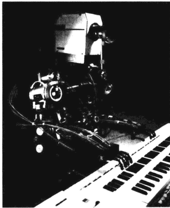
图 13.35 WABOT-2, 一个开发于 1985 年, 日本早稻田大学 (Waseda University) 的音乐机器人, 进一步工程化由住友商事 (Sumitomo Corporation) 完成。该机器人可以听懂语音要求 (日语) 且可以读乐谱, 使用风琴给歌唱者伴奏。机器人可以跟随歌唱者的表演 (音高及速度), 并且调整其自身的演奏以适应歌唱者。
